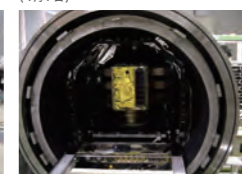
電子機器のトラブルの原因となるアウトガスを測定する試験(1月13日)
